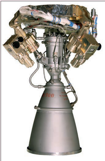
Главный двигатель 4-й ступени носителя Vega — модуля ориентации и доведения AVUM (Attitude and Vernier Upper Module).
