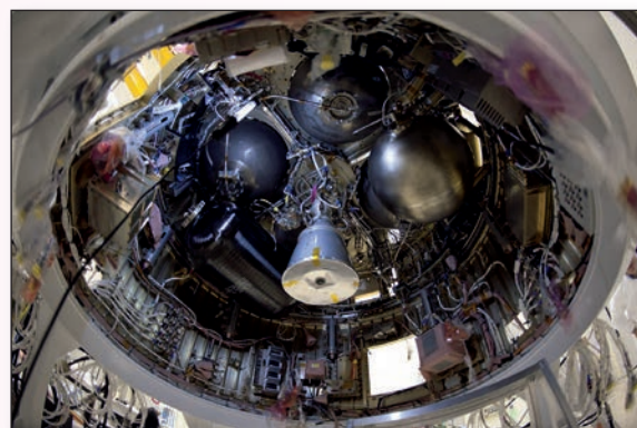
Двигатель 4-й ступени PH Vega, установленный на блоке AVUM
